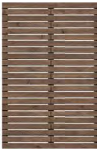
Vorderseiten: Profile 14 x 70 mm mit ca. 8 mm Fugenabstand Profile und Riegel gehobelt und gefast, Verbindungen aus Edelstahl
