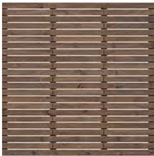
Vorderseiten: Profile 14 x 70 mm mit ca. 8 mm Fugenabstand Profile und Riegel gehobelt und gefast, Verbindungen aus Edelstahl
